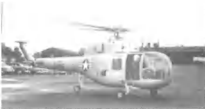
S-59 (ХН-39) конверсионный вариант S-52-3 с газотурбинным двигателем. 1950 г.
